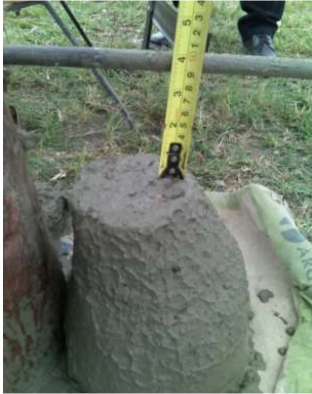
PRUEBA DE SLUMP
