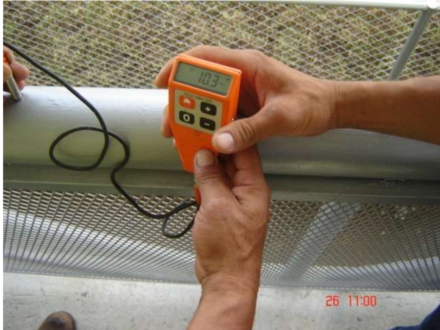
MEDICION DE ESPESORES DE PINTURA
